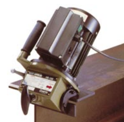
снятие фаски с криволинейных кромок
