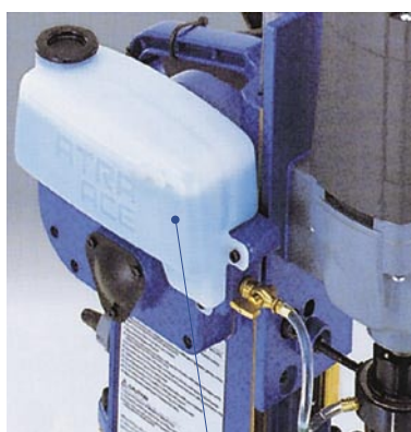
бачок со смазывающе-охлаждающей жидкостью
