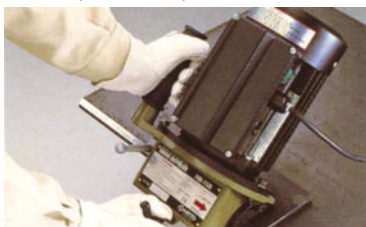
снятие фаски с кромки металлического листа
